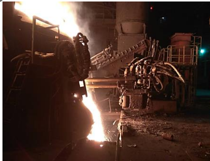
Рис. 2. Подача газокислородной смеси с использованием манипулятора рабочего окна
