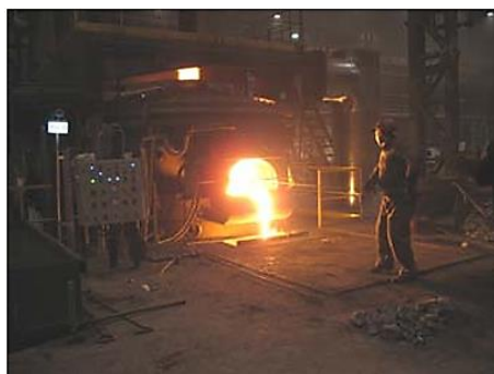
Рис. 1 Подача кислорода в печь до внедрения манипулятора рабочего окна
