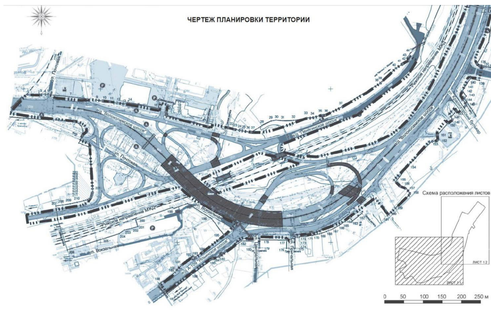
Рис. 2. Модель в AutoCAD Civil 3D развязки на пересечении Волоколамского и Ильинского шоссе в Красногорском районе Московской области
