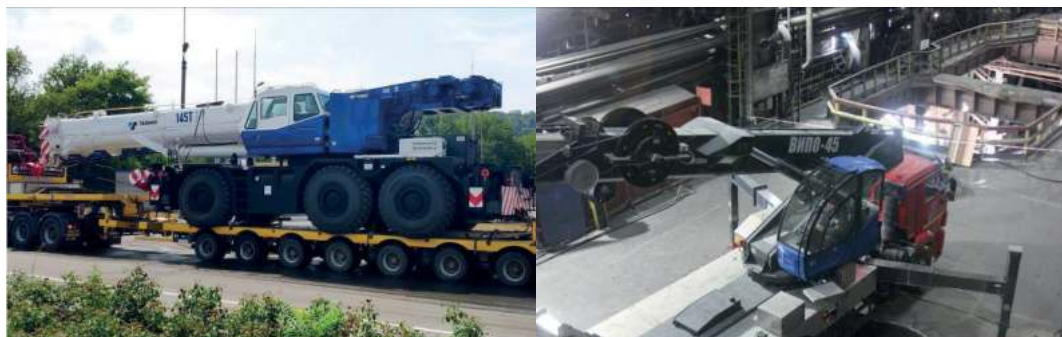
Спецтехника для капремонта газоочистки автокран 92 м, 145 т и автовышка 45 м
